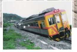
依照現場的狀況(魚尾板被拆掉,扣夾被打掉,丢在旁邊,鐵軌已錯開),及鐵路局員工的解釋説明,940621 案應該是人為的故意破壞!不是小偷想偷鐵軌上的物件而著手破壞,而是有意讓火車出軌。不過當時承辦警員不排除任何可能,所以也曾懷疑是否鐵路局人員施工疏失所造成的,但在調閱一些文件及詢問員工後,排除這個可能。
